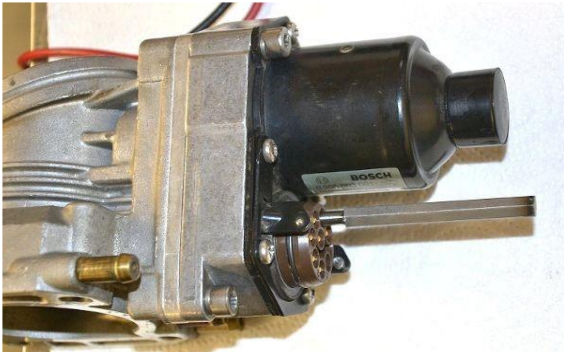
Bild 21: Drosselklappe mit eingesetztem Justierwerkzeug
