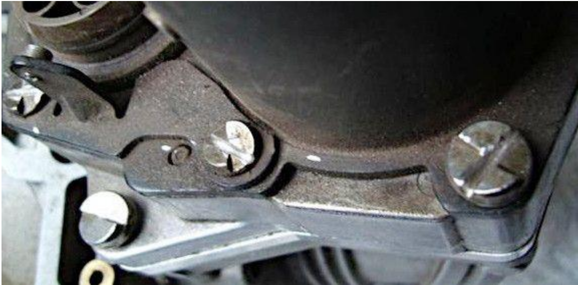
Bild 6: Schrauben die manipuliert werden können
