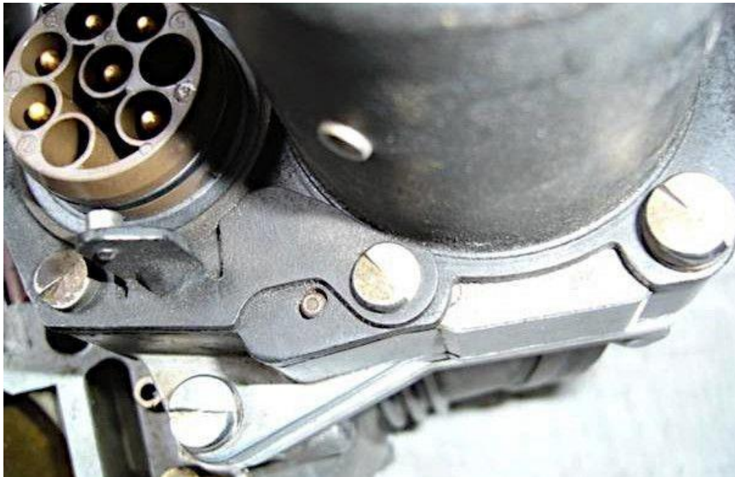
Bild 5: Vor Manipulation schützende Schrauben
